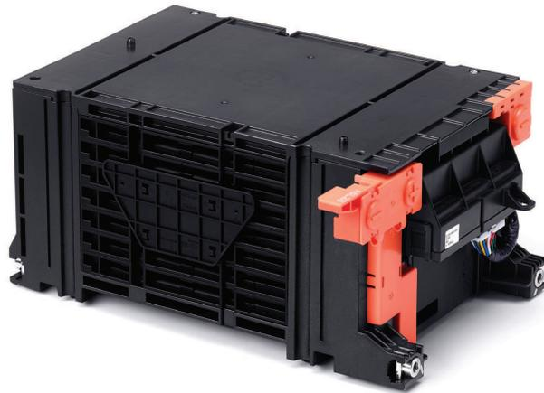
배터리 팩 하우징은 리튬이온 전지의 직렬 및 병렬로 연결된 셀들을 저장하는 부품으로, 외부 충격으로부터 셀을 보호하고 각각의 셀 전압과 온도를 센싱하여 충전 효율을 높이며 BMS(Battery Management System)의 단락 및 과충전 방지 시스템을 적용해 안정적으로 전기에너지를 공급합니다.
