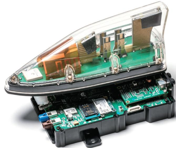
자동차의 멀티미디어 시스템(라디오, DMB, DAB, 위성라디오, 내비게이션)을 위한 방송 수신과 ITS(지능형 교통정보시스템)을 위한 양방향 통신이 가능한 안테나가 복합적으로 내장되며, 차량의 종류와 디자인에 적합화된 샤크핀(Shak Fin) 타입과 폴(Pole) 타입이 가능합니다. 송수신 신호를 낮은 손실로 시스템까지 안정적으로 전달하는 RF 케이블을 적용하여 차세대 서비스인 e-Call 및 자율안전주행시스템과도 연동된 안테나가 내장된다는 것이 장점입니다.
