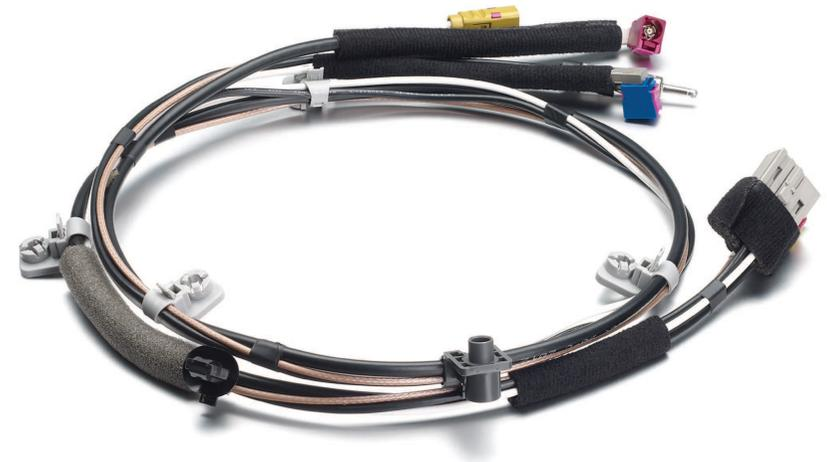
RF 신호를 유선상으로 목적하는 곳까지 전달하기 위한 전송 케이블로 특히 차량에서는 안테나로부터 수신된 다양한 전기적 신호(라디오, DMB, GPS, SDARS, LTE 등)를 수신단(오디오, AVN 등)까지 효율적으로 전달합니다. 주파수에 따른 손실을 최소화하기 위해 통상 RG316 계열 등을 많이 사용합니다.
